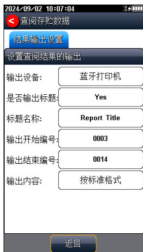
图 5-27 测量结果输出设置示意图
