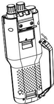
图 4-4 便携式腕带安装示意图
