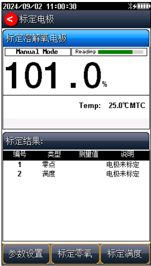
图 5-19 溶解氧标定示意图
