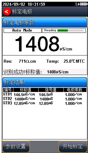
图 5-16 电极常数标定示意图
