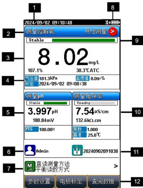
图 5-1 仪器显示屏幕示意图
